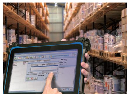
定谊科技DT395CR坚固型平板电脑整合了8.9英寸电容式触控屏，高效节能的Intel® Atom™四核心处理器，集轻薄、坚固耐用于一体。内置智能卡读卡机、Wi-Fi和蓝牙模块，并有可选的各式信息撷取模块，让这款强固型平板电脑提供无缝的信息采集和传输，改进了工作流程。DT395CR坚固型平板电脑拥有IP65防尘防水、MIL-STD-810G抗震防摔等级及宽温操作（-20°C ~ 60°C），能确保在恶劣、关键任务环境下可靠运行。
