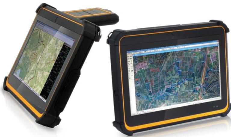
DT391GS拥有9英寸电容式触摸屏、英特尔最新双核处理器，并基于Windows®系统，易于整合现有各式GIS系统软件。有了DT391GS，使用者可透过触摸屏或利用各式可选模块进行数据录入、使用高精度卫星定位，并利用GIS系统管理分析，完成现场实时成图和编辑，最终通过Wi-Fi、蓝牙或3G进行数据传输。数字化勘查测图代替常规的纸笔手绘流程，有效防止手绘草图在操作中漏测、重测，漏标或重标。DT391GS平板电脑具有防水、防尘与防震的机体设计，在室外恶劣环境下也能正常操作，降低人员的工作强度，同时增进效率。
